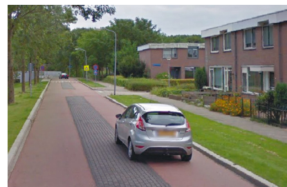
▲ Almere (Pays-Bas), Gorinchemgracht: une bande centrale franchissable en pavés légèrement bombée réduit visuellement chaque sens de circulation à quasiment 2 m. C'est un des aménagements standards des vélorues néerlandaises à double sens pour les motorisés. (Google Street View)
