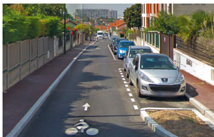
▲ Villejuif, rue Jean-Jacques Rousseau : les pictogrammes fléchés du contresens cyclable au milieu de la chaussée poussent à ne pas rouler à contresens au ras des portières. (Google Street View)
